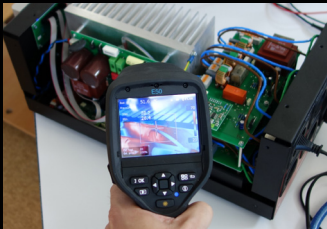
Wärmebildkamera zur Überwachung
